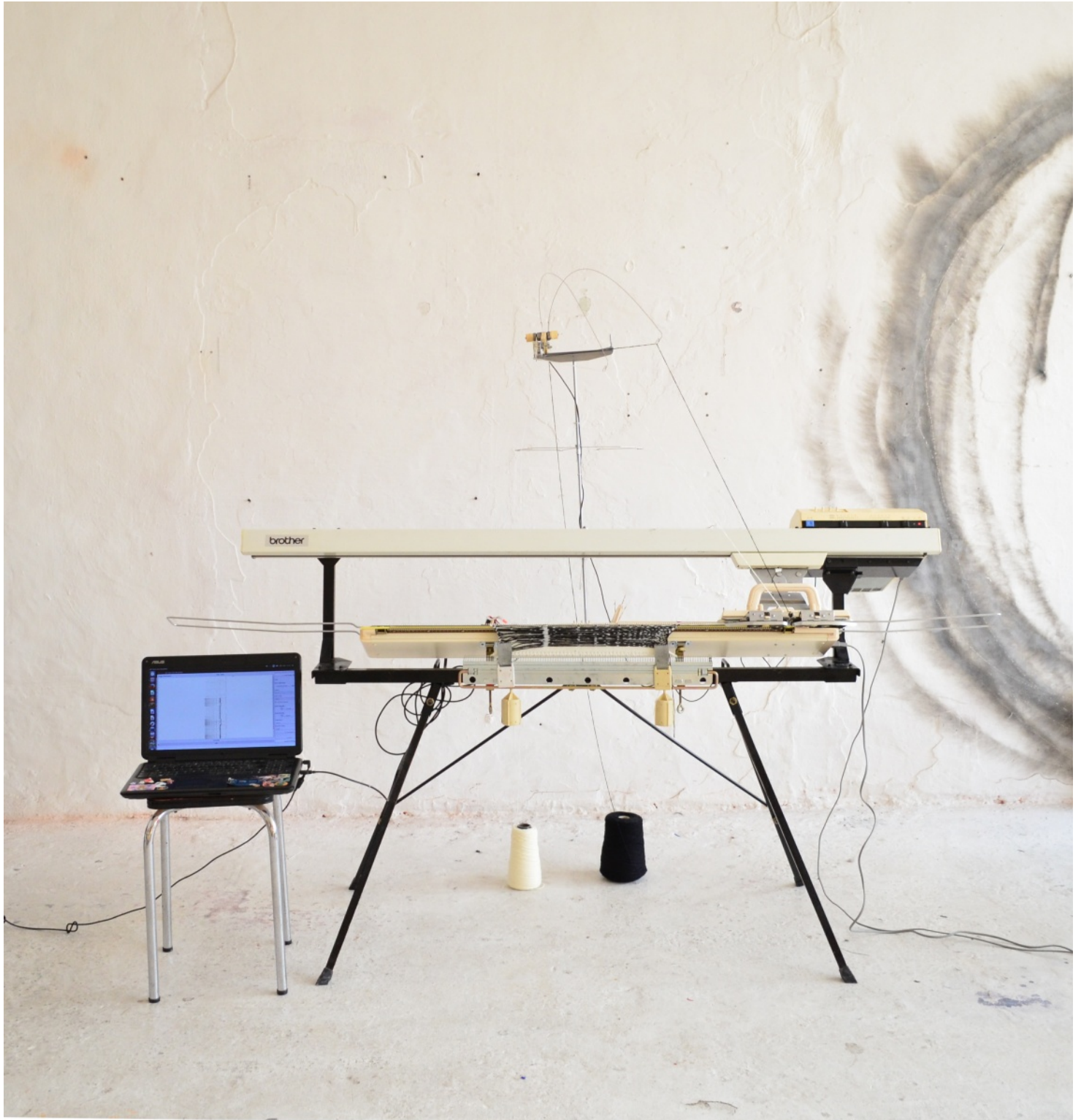
Machine à tricoté hackée des années 80. Elle a été modifiée au niveau de son système électronique afin de la connecter à un ordinateur moderne.
