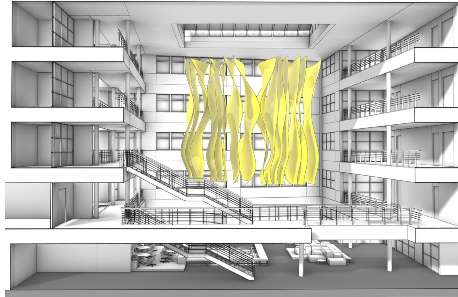
Le filet serait accroché directement à l'architecture existante tout en s'y adaptant et réduisant ainsi les couts d'installation d'une structure truss.
